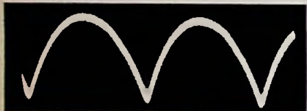
Bild 5. Parabel-Impulse an den Siebgliedern der Vertikal-Ablenk-Stufe. Sie dienen als Steuerimpulse für die Flip-Flop-Stufe (Bild 3); Impulsdauer: 20 µs
