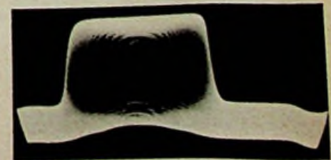
Bild 2. Impulsfolge am Wehneltzylinder der Bildröhre zur Hellsteuerung einer Kreisfläche (nach Gleichung 1 und 2). Zur besseren Erkennbarkeit wurde ein Teil der Impulsfolge ausgetastet. Die Ablenkfrequenz des Oszillografen entspricht der Zeilenfrequenz
