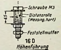
Bild 18. Anordnung und Maße der Tonköpfe und Umlenkrollen
