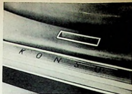
Bild 1. Einblicktubus für „Magisches Band“ am Nordmende-Empfänger „Konsul“
