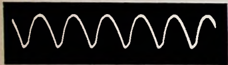
Bild 4. Parabel-Impulse am Boosterkondensator. Sie werden als Schaltimpulse für die Flip-Flop-Stufe (Bild 3) benutzt; Impulsdauer: 64 µs
