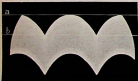
Bild 6. Am Steuergitter der Flip-Flop-Triode überlagerte Impulsform. Zwischen a und b liegt der Arbeitsbereich der verschiebbaren Schwellenspannung
